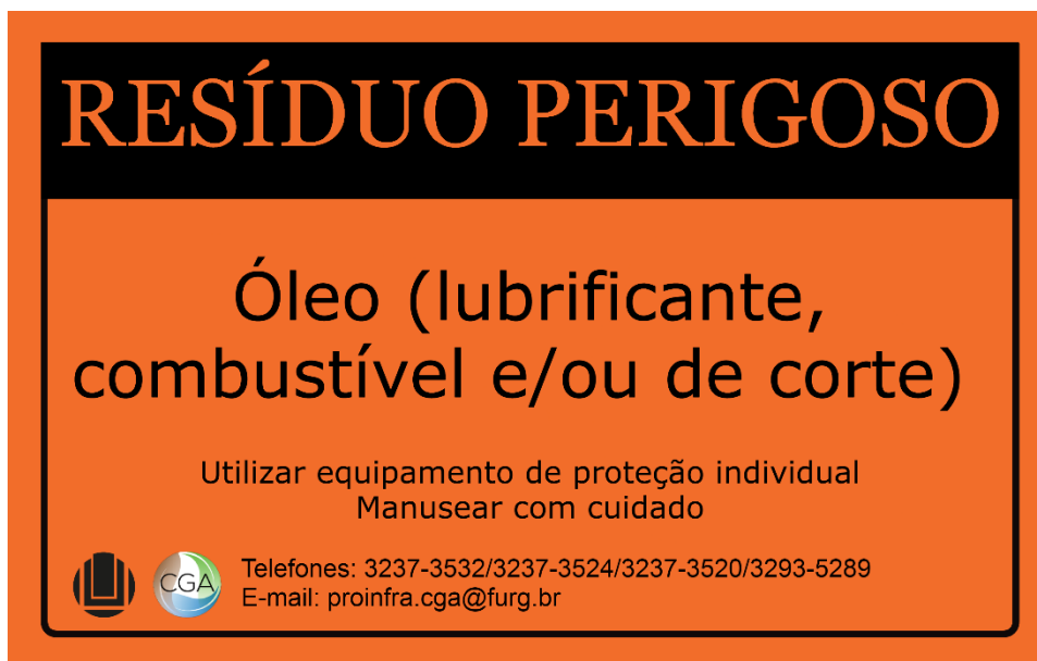
Figura 8 - Identificação para recipientes com OLUC e óleo combustível de limpeza de peças engraxadas
