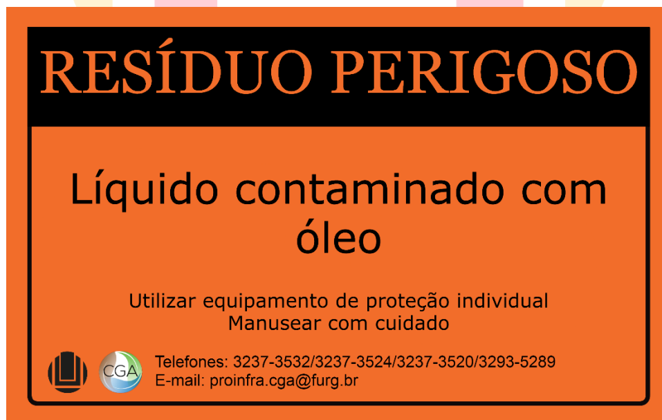
Figura 9 - Identificação líquido contaminado com óleo
